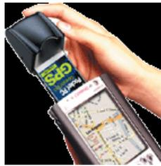
Figura 1 - Pocket PC com módulo GPS
