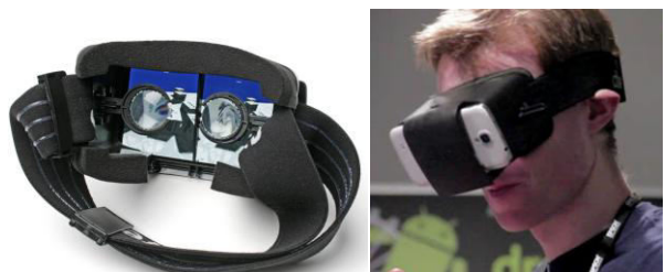
Figura 4: Equipamento Durovis. Imagem dupla no Smartphone e as lentes (à esquerda). Usando o equipamento imersivo (à direita).
